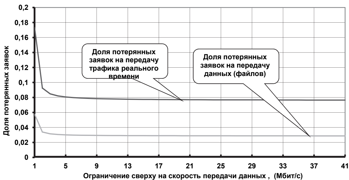
Рис. 3. Зависимость потерь заявок от увеличения максимальной доступности ресурса для передачи эластичного трафика.
