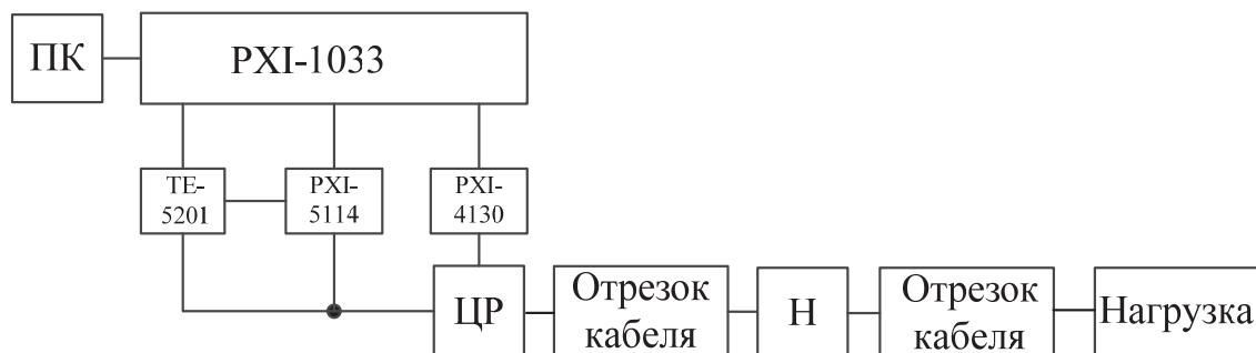
Рис. 1. Структурная схема устройства. ПК – персональный компьютер; NI PXI-1033 – модульная платформа; TE-5201 – блок ЦАП; NI PXI-5114 – блок АЦП; NI PXI-4130 – источник тока; ЦР – цепь развязки по постоянному току; Н – неоднородность.
