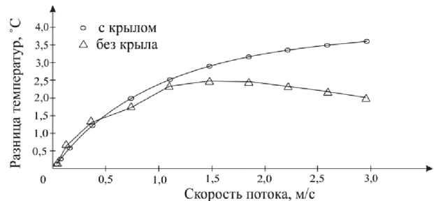
Рис. 5. Зависимость разности температур терморезисторов при конфигурациях с крылом и без крыла.
