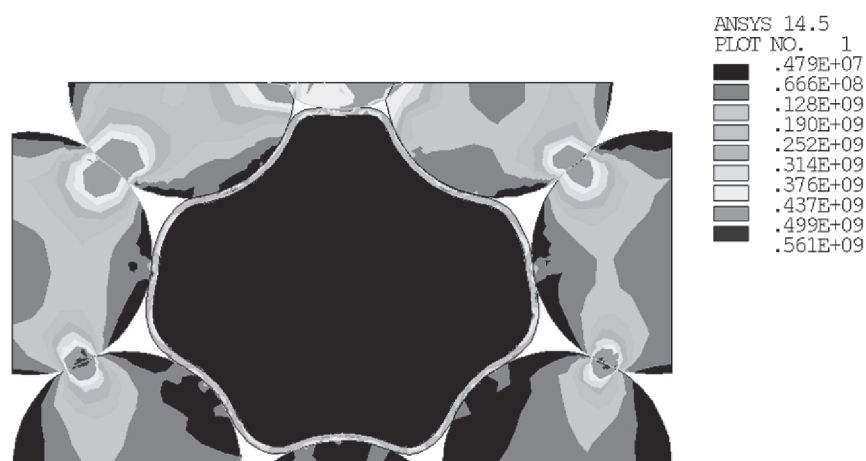
Рис. 3. Распределение эквивалентных напряжений по Мизесу в области контактного взаимодействия компонентов порошковой металлополимерной системы, содержащей фрагменты частиц меди и частицу плакированного полимера, одну углеродную нанотрубку и две луковичные наноструктуры углерода, Па.
