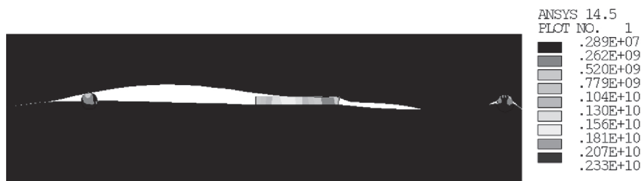
Рис. 4. Распределение эквивалентных напряжений по Мизесу в области контактного взаимодействия компонентов порошковой металлополимерной системы, содержащей фрагмент частицы меди, фрагмент частицы плакированного полимера, одну УНТ, расположенную горизонтально, и две ЛНУ, каждая из которых расположена по разные стороны относительно УНТ, Па.
